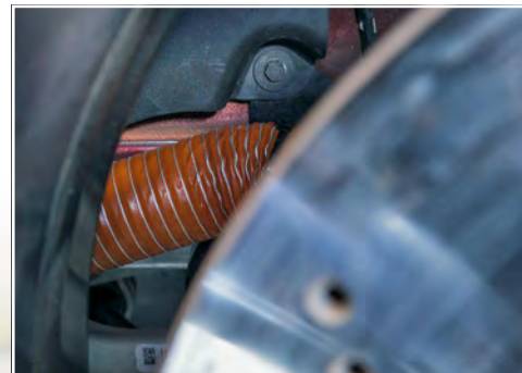
Für den Test wurden spezielle Motorsport-Bremsbelüftungsschläuche verbaut
