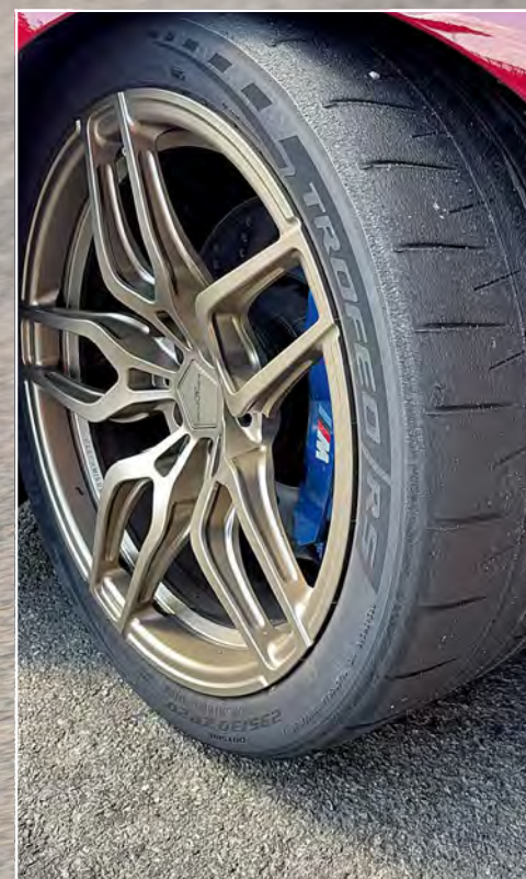
Das schwarze Gold! Die Pirelli Trofeo RS in 295/30 R 20 rundum. Breiter als die Serie und im Zusammenspiel mit dem Fahrwerk gefühlt deutlich mehr Grip als mit den bisherigen Michelin Cup 2 R
