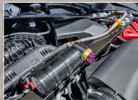
Die Ausgleichsbehälter des KW-V4-Clubsport-Gewindefahrwerks wurden an den Streben im Motorraum befestigt
